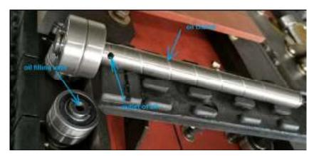
Todas las superficies deslizantes (incluido el movimiento del transportador frontal, la sección móvil de la viga de rectificado, las placas del motor) están lubricadas por un sistema de aceite. El sistema de lubricación de aceite bien diseñado asegura la vida útil de la máquina y un funcionamiento suave durante mucho tiempo.
