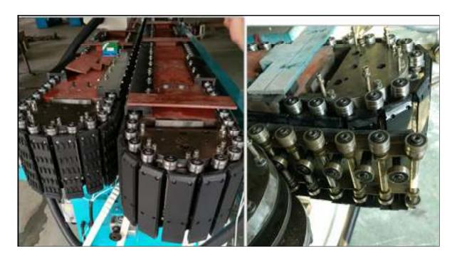
**4.** La máquina tiene un mecanismo de protección del espesor del vidrio. Cuando se coloca vidrio de grosor incorrecto en la máquina. La máquina se detendrá automáticamente. Esto protege los cojinetes de aplastamiento.
