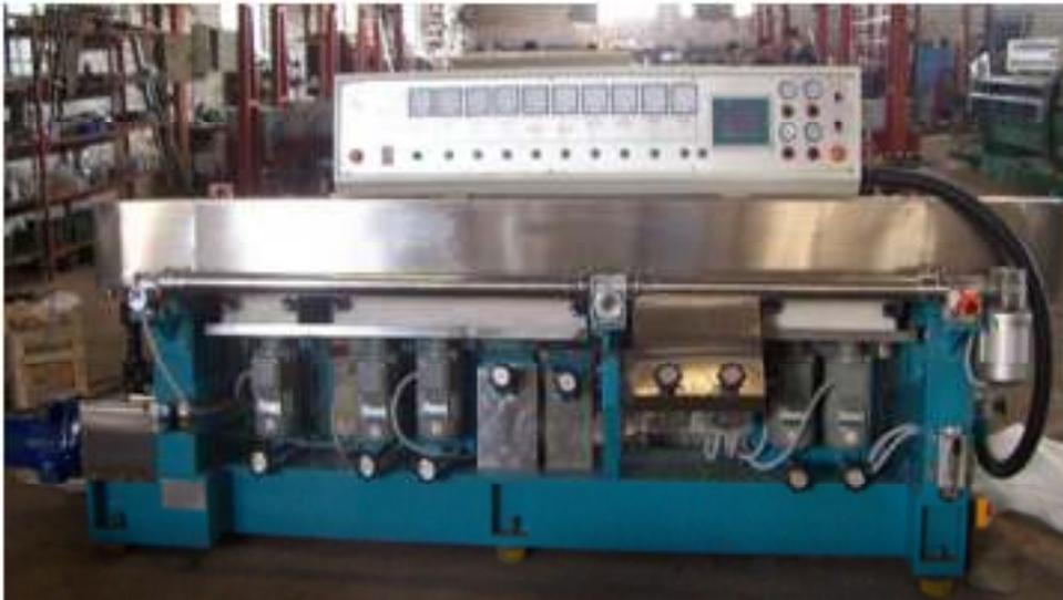
**La máquina está diseñada para pulir el borde inferior del vidrio plano, así como sus aristas.**
